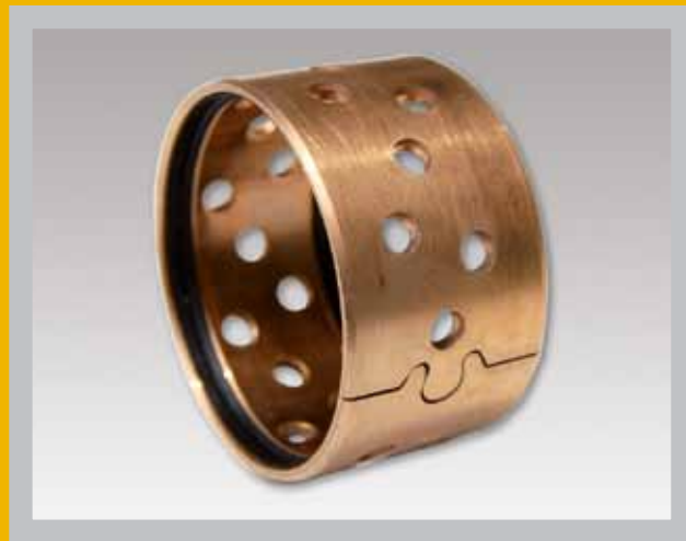
GEROLLTES BRONZEGLEITLAGER, LOCHDEPOTS, DICHTUNG, WARTUNGSARM
