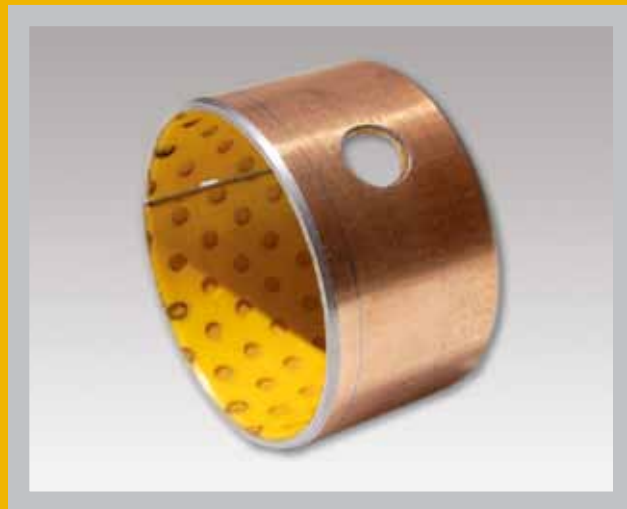
GEROLLTES VERBUNDGLEITLAGER, STAHL / ACETALHARZ (POM), SCHMIERTASCHEN, WARTUNGSARM
