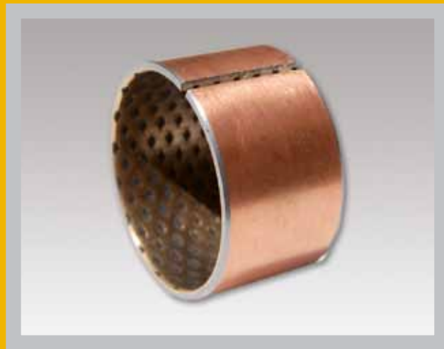
GEROLLTES VERBUNDGLEITLAGER, STAHL/BRONZE, GEFÜLLTE SCHMIERMITTELDEPOTS, WARTUNGSFREI
