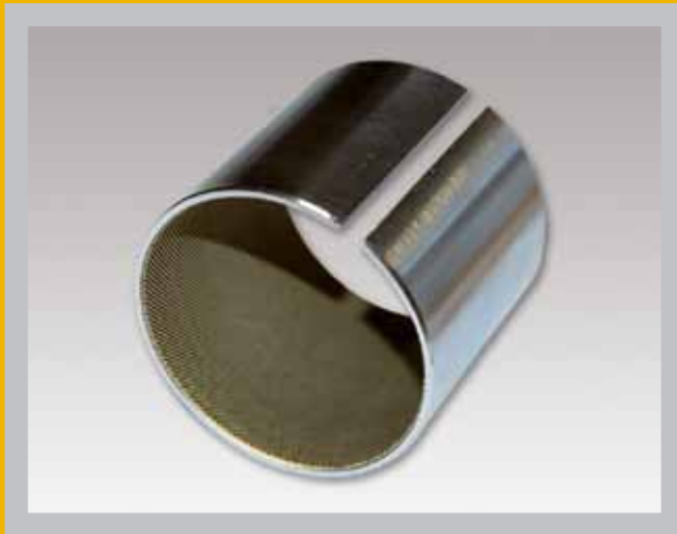
GEROLLTES VERBUND-GLEITLAGER MIT PTFE-GEWEBE, WARTUNGSFREI
