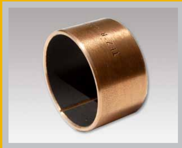
GEROLLTES VERBUNDGLEITLAGER, BRONZE/PTFE, WARTUNGSFREI
