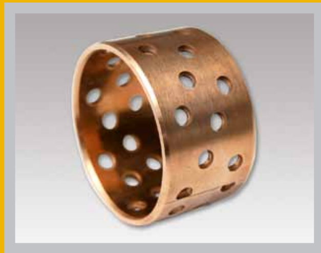
GEROLLTES BRONZEGLEITLAGER, LOCHDEPOTS, WARTUNGSARM
