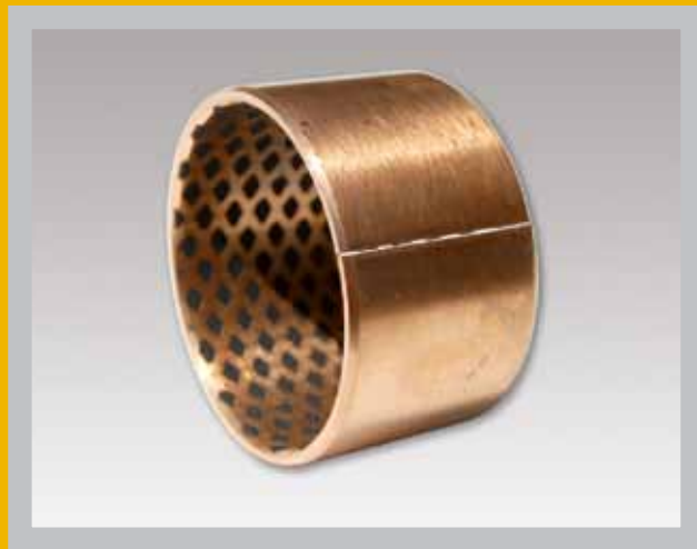
GEROLLTES BRONZEGLEITLAGER, GEFÜLLTE SCHMIERMITTELDEPOTS, WARTUNGSFREI
