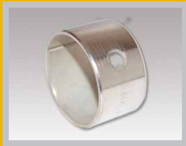
GEROLLTES VERBUNDGLEITLAGER, STAHL/ALULEGIERUNG, WARTUNGSPFLICHTIG
