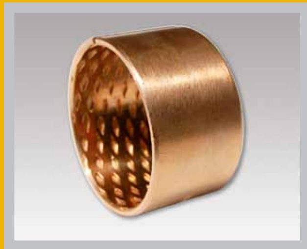
GEROLLTES BRONZEGLEITLAGER, SCHMIERTASCHEN, WARTUNGSARM
