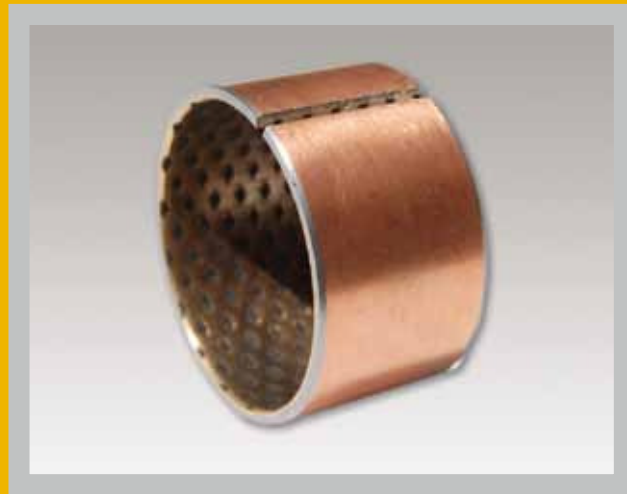
GEROLLTES VERBUNDGLEITLAGER, STAHL/BRONZE, GEFÜLLTE SCHMIERMITTELDEPOTS, WARTUNGSFREI
