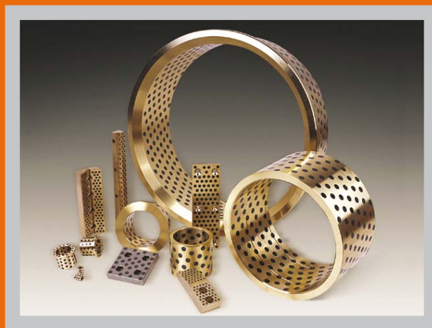
GEDREHTES BRONZEGLEITLAGER , GEFÜLLTE FESTSCHMIERSTOFFDEPOTS, WARTUNGSFREI
